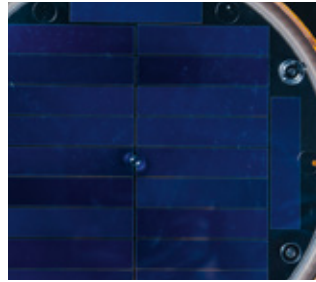
Solarmodule Hochleistungszellen. Maximum Power Point Tracking (MPPT) für optimale Energiegewinnung.
